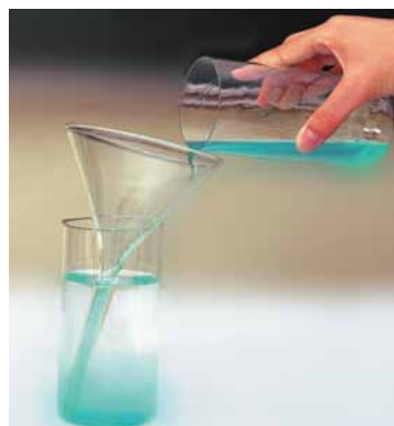
Рис. 2.4. За допомогою лійки можна акуратно налити мідний купорос на дно склянки з водою
